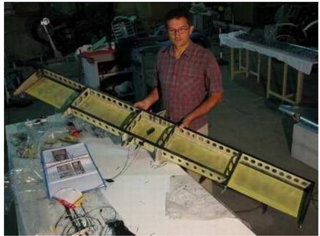
Assemblaggio piano di coda
